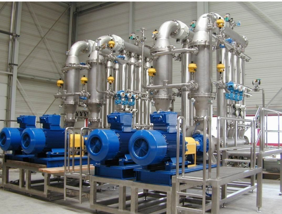
УФ установка для отбивки биомассы после ферментации, производительность по фильтрату 12 м 3 /час, пл. мембраны 256 м 2
