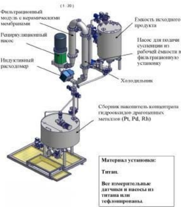
Фильтрационная установка для отмывания от Na + , Cl - и концентрации гидроксидов драгоценных металлов (Pt, Pd, Rh)
